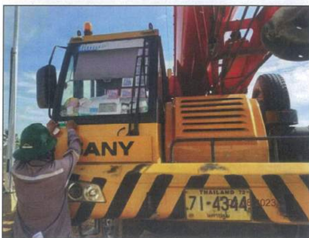
รูปที่ 2-5 การติดแถบสีสติกเกอร์แสดงการตรวจสอบของเครื่องจักรและอุปกรณ์ต่างๆ
